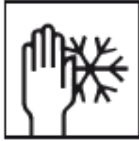
Frostsicher transportie- ren u. lagern
